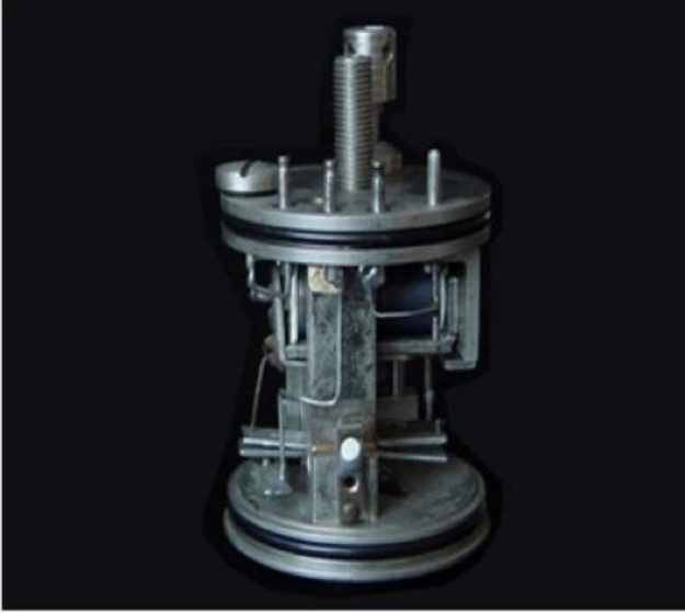
Şekil 1: 1919 Fizik Profesörü Wilhelm Hammer'ın Elektrostatik role icadı, bunu sayesinde çok Düşük elektrik yükleri hassas bir şekilde ölçülmeye başlandı.
